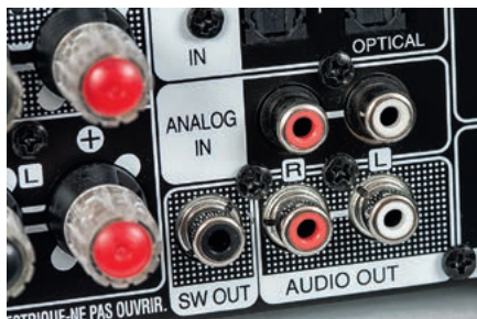
Amplituner ma jedno standardowe wyjście audio na parze RCA oraz gniazdo pozwalające na podłączenie aktywnego subwoofera.
