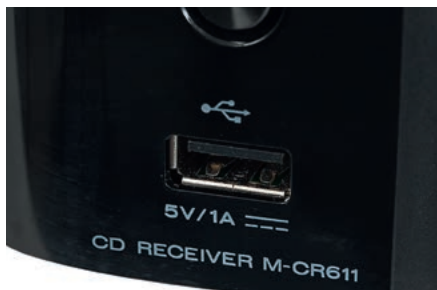
USB może obsłużyć pendrajwy z plikami, ale również urządzenia przenośne iOS. Na tylnym panelu znajdują się drugie gniazdo o identycznej funkcjonalności.
